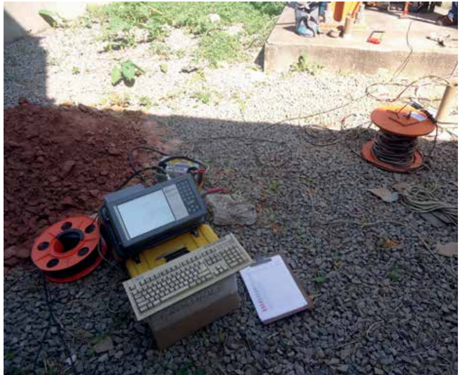
Figura 5 – Equipamentos utilizados no ensaio PS
