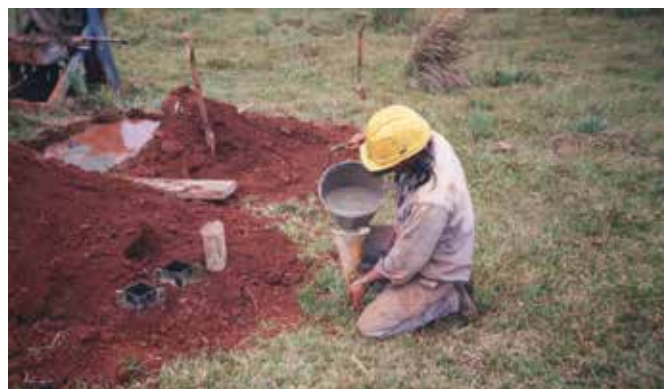
Análise da viscosidade da calda de injeção no funil
